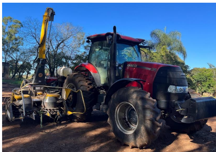
Figura 3 – Conjunto trator ensiladora (trator 4x2 TDA, marca Case modelo Puma de 170 CV e ensiladora marca JF, modelo JF 1600 AT). Utilizado na ensilagem do Capim Capiçu, BRS Capiçu. Fonte autoria própria.
